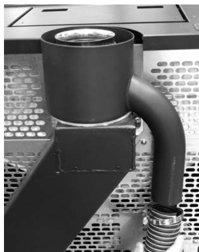
Fig. 58 - Conexión de 2 entradas
