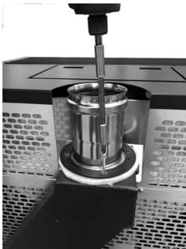
Fig. 52 - Desenroscar la descarga
