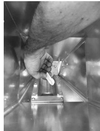
Fig. 66 - Extracción del cojinete
