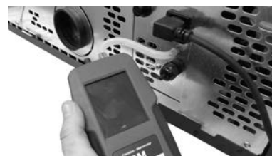
Fig. 61 - Conexión del presostato digital Modo At y Quasimod³ Up
