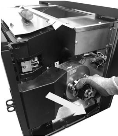
Fig. 70 - Extraiga el ventilador
