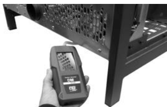
Fig. 60 - Conexión del presostato digital Frame³
