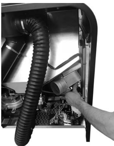
Fig. 47 - Fije el cárter y el ventilador a la estufa
